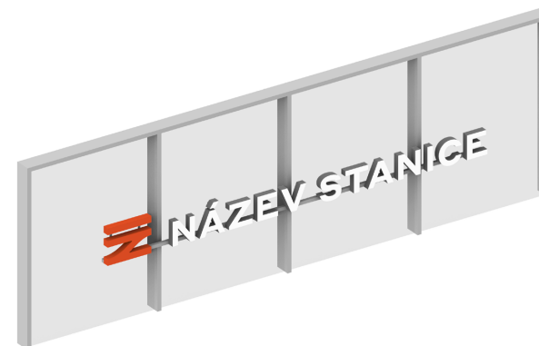
Obr. 8.6.2.3 Montáž písmenného názvu na fasádu objektu – společné napájení pro písmenný název je vedeno v nosném profilu
