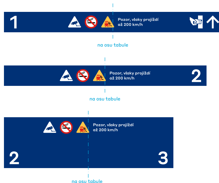
Obr. 10.16.4.1 Předepsané umístění piktogramu Pozor na vlak u nástupní hrany
