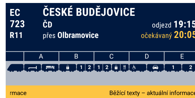
Obr. 14.14.2 Nástupištní displej se zobrazením řazení vlaků – samostatná lokomotiva se zobrazuje mimo sektory
