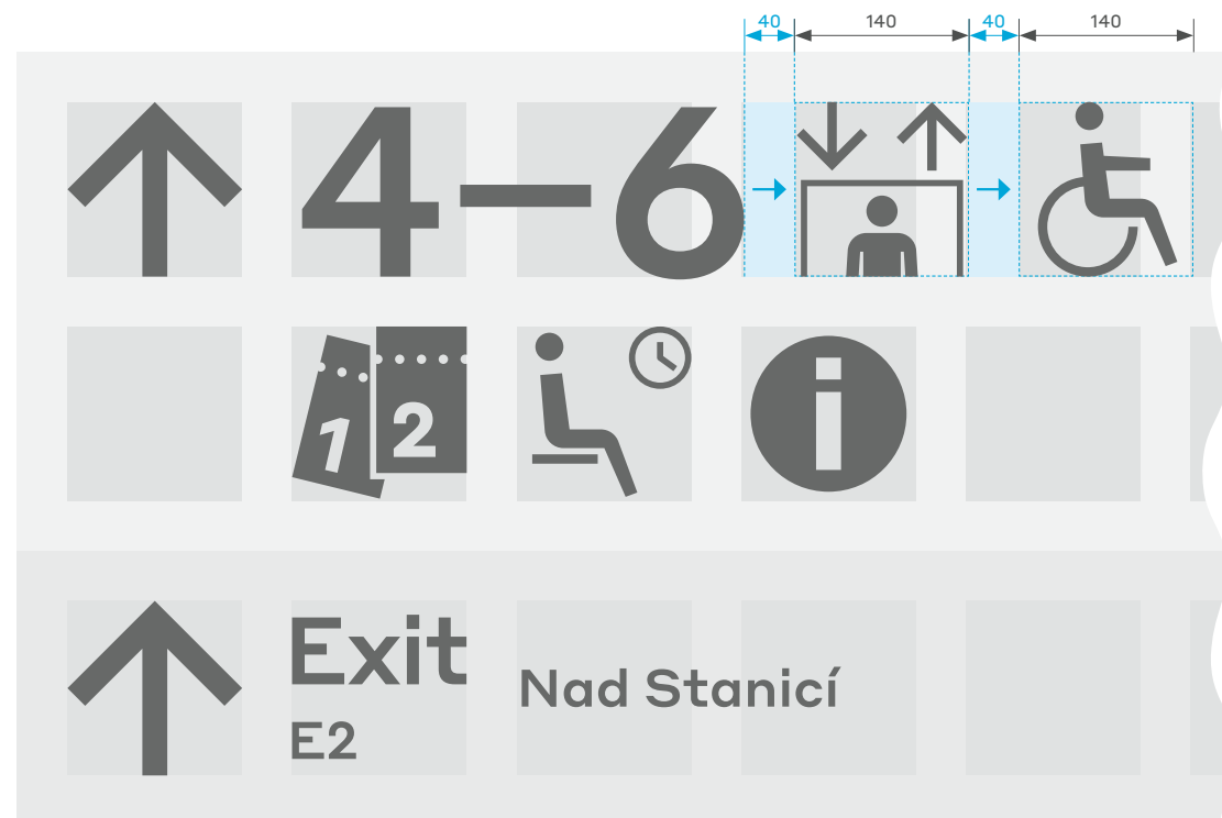
Obr. 10.8.11 Dlouhá označení kolejí v mřížce a zarovnání následujících piktogramů (3 : 20)
