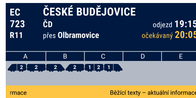
Obr. 14.14.1 Nástupištní displej se zobrazením řazení vlaků – lokomotiva, která je součástí soupravy, se zobrazuje v sektorech
