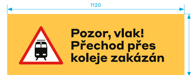
Obr. 11.6.7 Výstražná tabule Pozor vlak – přechod přes koleje zakázán
