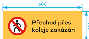
Obr. 11.6.5 Zákazová tabule Přechod přes koleje zakázán u služebního místa pro přecházení kolejí podle ČSN 73 4959
